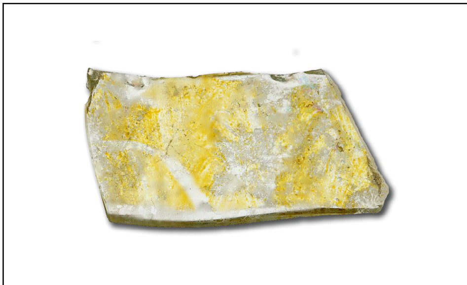
Tesson n° 1. Un morceau de verre coulé, blanc, partiellement coloré au jaune d'argent, partiellement matifié par application d'acide, d'une épaisseur de 6 mm.
