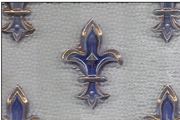
Verre imprimé n° 18 à motif de fleurs de lys, constitué de petits éléments identiques et régulièrement espacés.
